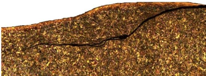
Рисунок 2. Общий вид трещины в приповерхностном слое поверхности катания бандажа локомотивного колеса
